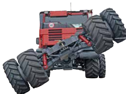
Hinterwagen in extremer Verdrehung zur Kabine (max. +/- 30°)
