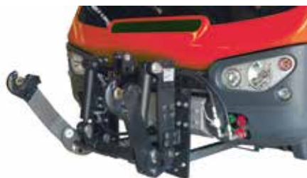
Hydraulisches Fronthubwerk (Option) für VT450 Vario
