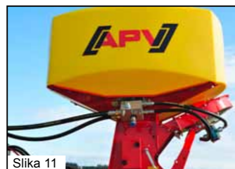
Slika 11: Namestitev naprave PS na GP 600 M1
