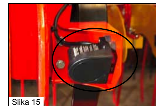
Slika 15: Radarski senzor (GP 300 M1)
