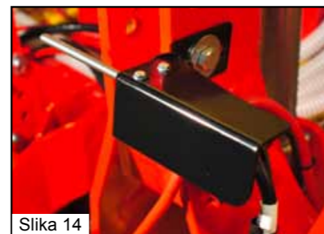
Slika 14: Senzor na zgornjem priključnem drogu dviznega mehanizma (GP 300 M1)
