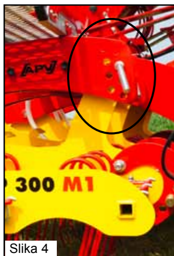
Slika 4: Višina strgalnega segmenta
