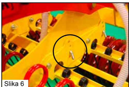
Slika 6: Nastavitev globine 8-milimetrskih zob
