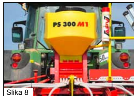
Slike 8, 9 in 10: Namestitev naprave PS na GP 300 M1
