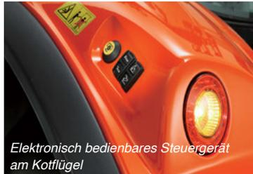
Elektronisch bedienbares Steuergerät am Kotflügel
