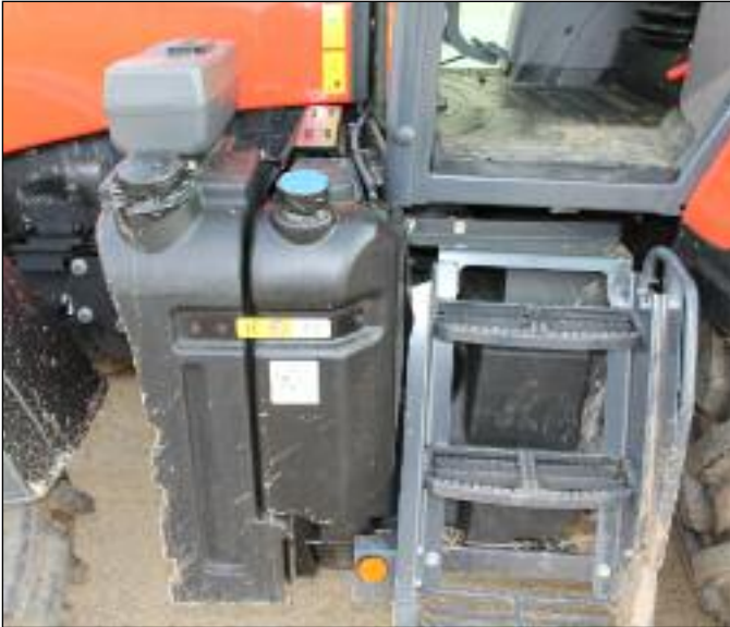
Stopnice, rezervoar za gorivo in sečnino. Nad rezervoarjema je tudi škatla za orodje.
