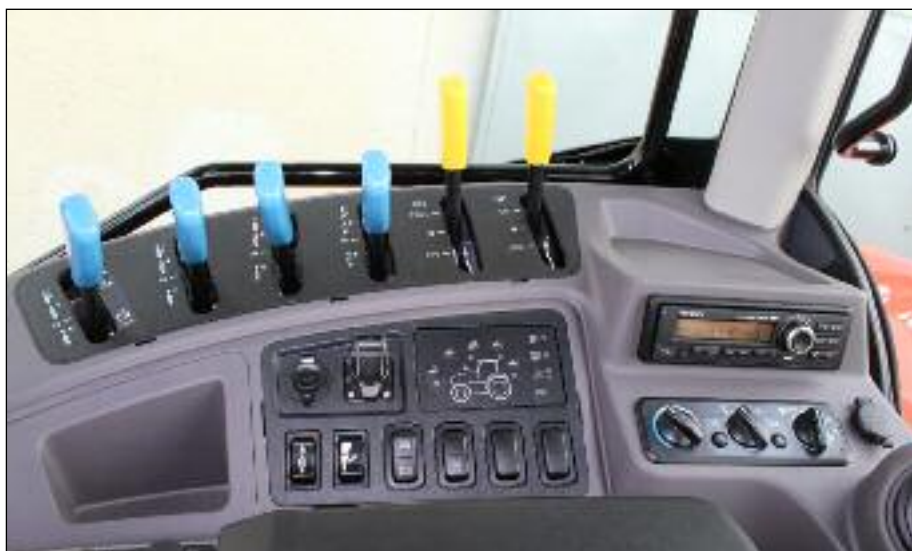
Levo so štiri ročice za regulacijo hidravličnih izhodov (standardni in plavajoči). Rumeni ročici sta za uravnavanje priključne gredi, in sicer za način in hitrost upravljanja. Spodaj so tipke za razsvetljavo.
